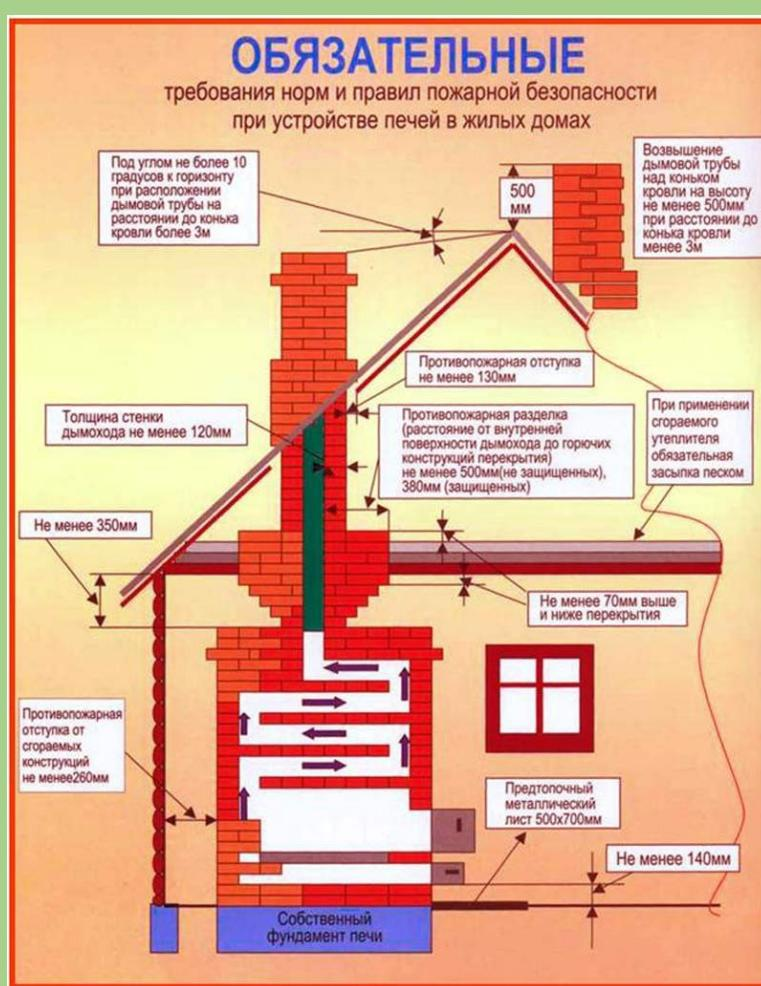
соединения с деревянными чердачными или межэтажными перекрытиями должны иметь утолщения кирпичной кладки - распушку. Не нужно забывать и про утолщение стенок печи. Для стыковки массива печи с деревянными перегородками применяется противопожарная разделка.
